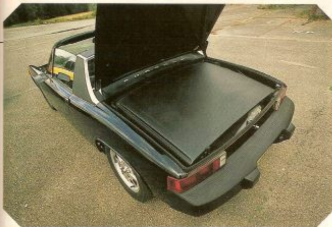
Onder het kofferdeksel van de VW-Porsche 914 is er ruimte voor het afneembare targadak.
