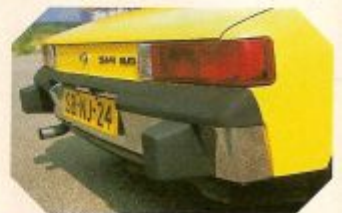
De 914's die naar Amerika gingen kregen eerst rubber stootblokken op de bumpers. Later moesten dikke bumpers met een 'kreukelzone' worden gemonteerd.
