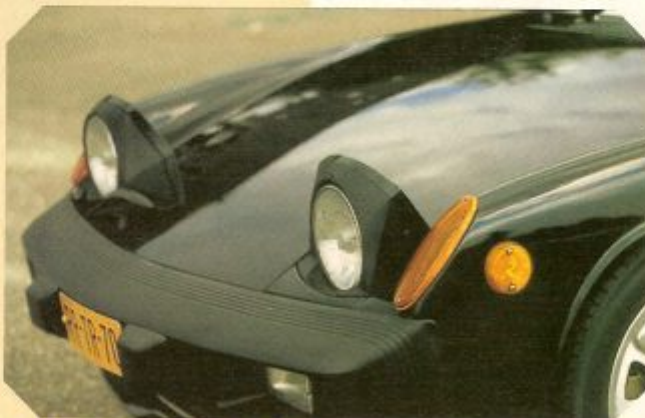
Met z'n lage aflopende neus had de 914 opklapbare koplampen nodig.
